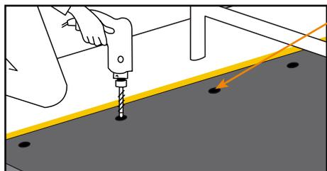
fissare nel bordo anteriore attraverso i punti predisposti per il fissaggio
