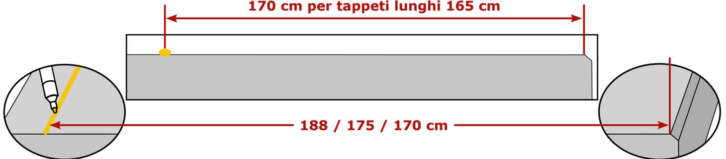
tracciare una linea per il posizionamento nella parte anteriore
