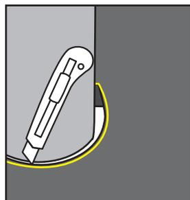
In caso di necessità intagliare degli spazi nei tappeti per le strutture che emergono dal pavimento
