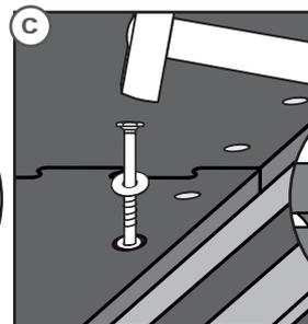
Piantare viti e rondelle fino a che appoggiano uniformemente e si incassano leggermente sotto il livello della gomma.
