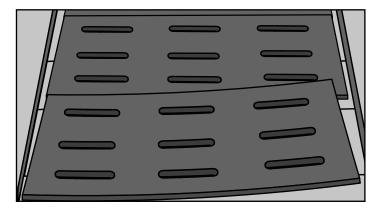
posizionare le fessure dei tappeti in gomma esattamente sulle fessure dei grigliati in cemento
