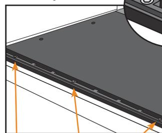
Fissare il bordo del tappeto attraverso 3 elementi di fissaggio
