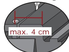
Inserire il fissaggio a una distanza di max. 4 cm dal bordo superiore
