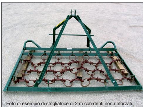
Foto di esempio di strigliatrice di 2 m con denti non rinforzati
