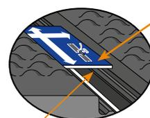
per la posa allentata stabilire la distanza tra i tappeti con l'aiuto dei calibri di montaggio (più larghi del profilo)
